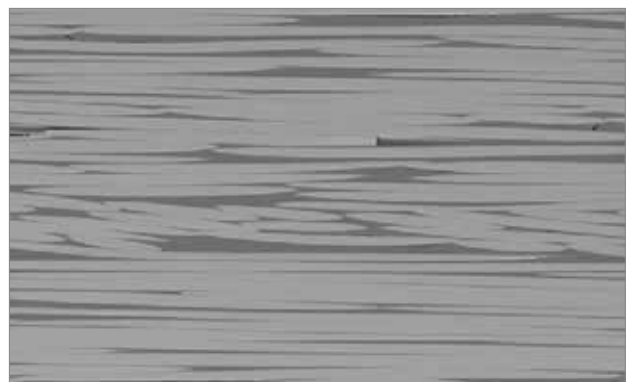
Abb. 4: Schöck Combar®: Längsschnitt durch den Stab
